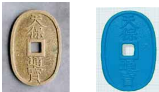
図IV-4-5 天保通宝の実物画像と3次元データ 左は実物画像、右は取得した3次元データの画像である。
