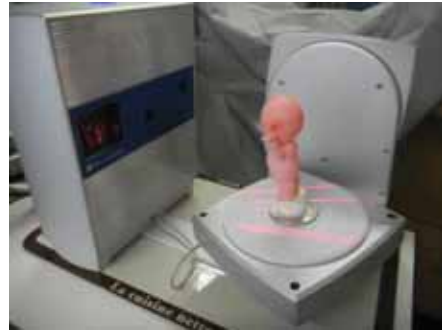
図 IV-4-2 3Dスキャン作業の例
