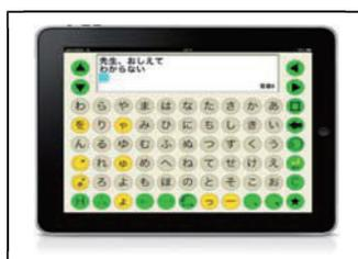
※文字盤を押して音声化される装置
