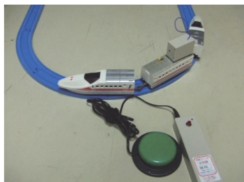
図 4-1-4 無線スイッチでプラレールを制御している様子
