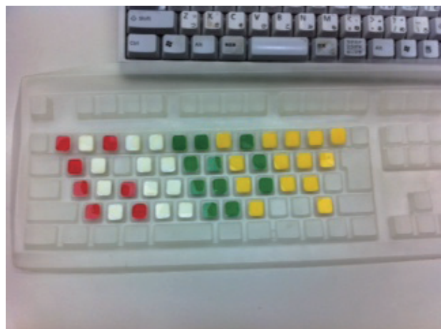
図3-36-3 シリコンゴム製のソフトキーボードカバーにシールを貼り、キートップが見えないようにしたカバーの外観
