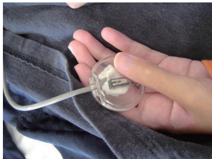
図 3-16-2 作業療法士によって製作されたスイッチ
