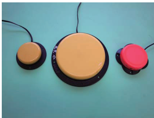
図 3-33-1 使用した丸形プッシュスイッチ (左から, a. ジェリービーンスイッチ, b. ビッグスイッチ, c. たっちぴこ)
