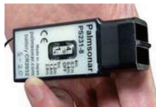
図 3-30-1 パームソナーを手のひらに装着したところ
