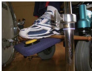
図 3-21-2 ジェリービーンスイッチを置いて足でバスドラムを装置でたたく様子
