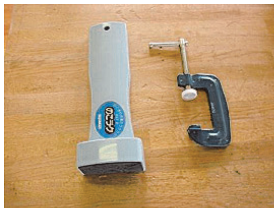
写真3 のこびき用治具とクランプ
