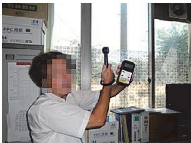
写真2 計測装置で紫外線量を計測
