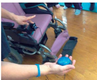
図8 ジョイスティックコントローラーの使い方
