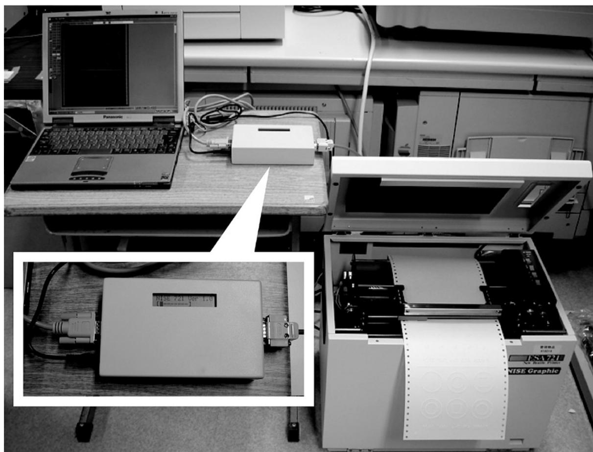
図1 出力コンバータの接続状況
