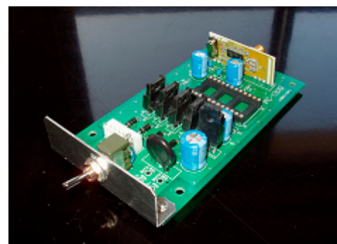
図6 トランジスタ利用の制御ボード
