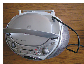
図 4-10 CDプレーヤーへのジャック取り付け
