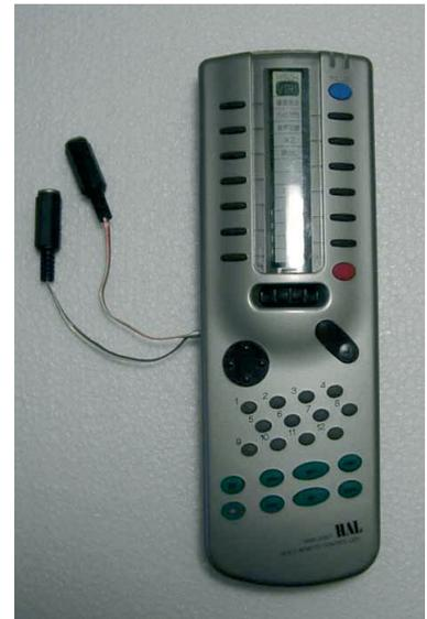
図2-2-1 学習型赤外線リモコン「クロッサム2+」
