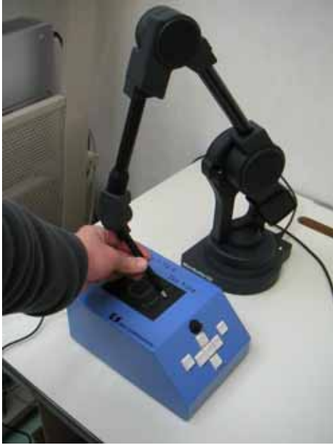
図 2 視覚障害児・者用触図描画システムの外観
