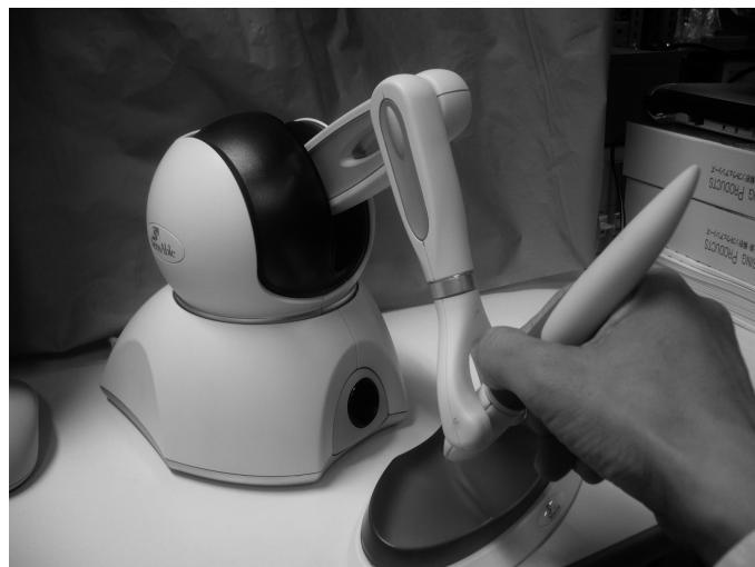
図I-11 3次元データ編集装置「CrayTools system」の入力デバイス
