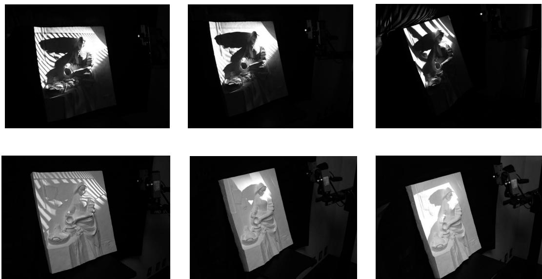
図I-6 3次元形状データの取得作業中の様子
