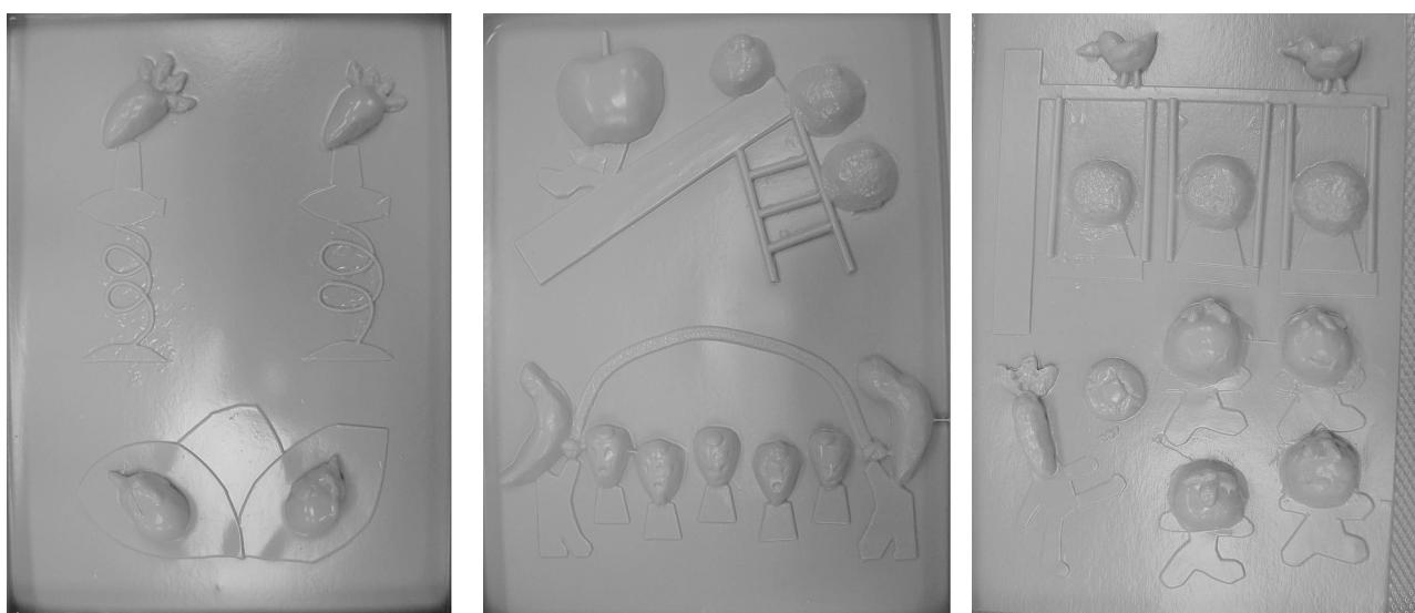
図II-28 真空成型で翻案した小学校算数導入期の触図
