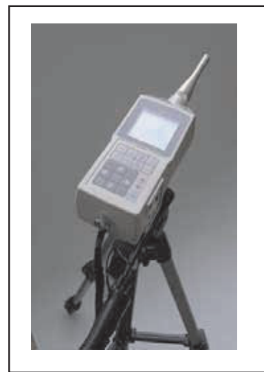
図9 音圧を測定した精密騒音計
