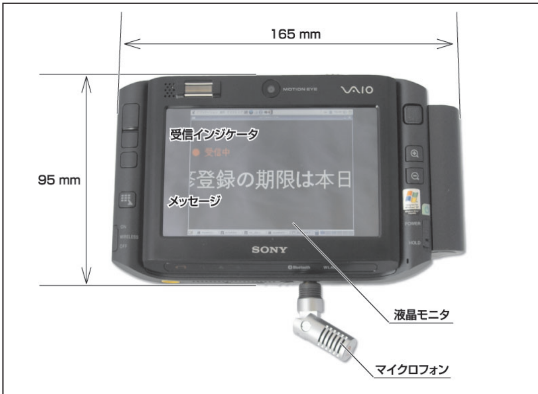
図4 システムの外観 (寸法)
