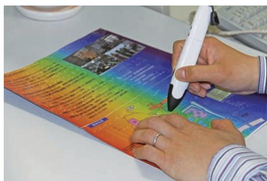
【共同研究】無色透明な紫外線硬化樹脂インクを用いた触知図・点字に関する製作システムの開発とそれらの触読性評価に関する研究に係る、触知図（左）とその作成機器（下）
