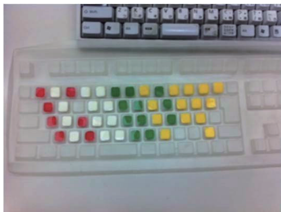
図 4-36-3 シリコンゴム製のソフトキーボードカバーにシールを貼り、キートップが見えないようにしたカバーの外観
