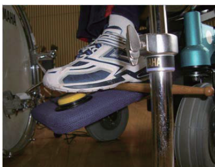
図 4-21-2 ジェリービーンスイッチを置いて足でバスドラムを装置でたたく様子
