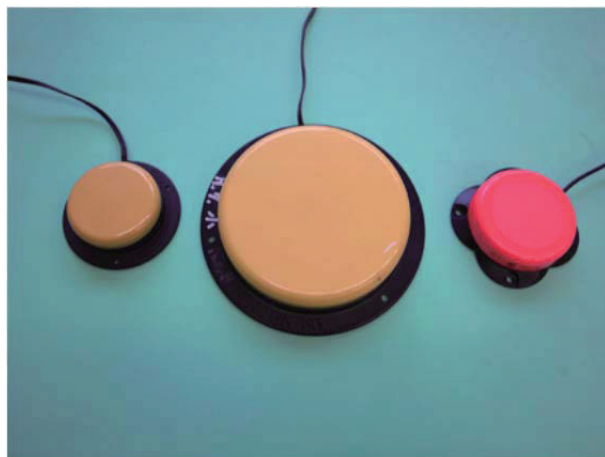
図 4-33-1 使用した丸形プッシュスイッチ（左から、a. ジェリービーンスイッチ、b. ビッグスイッチ、c. たっちぴこ
