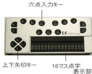
図 3-28-1 ブレールメモポケットの外観
