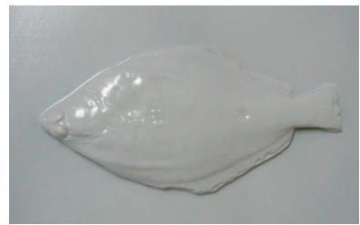
図 3－2－3 魚の成型教材例（鰈：シート厚 0.3mm）
