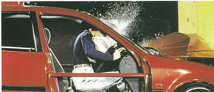
図16 自動車の衝突実験 シートベルトをしていないと大変危険である。
