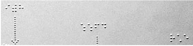
図14a 点字パターンが変形して出力される例 (点字プリンタ出力による)
