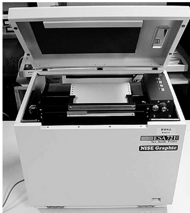
Fig. 1 点字プリンタ “NISE Graphic” の外観
