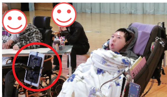
図 5-13-2 固定した iPad でまばたきの動きを感知し、接続した Bluetooth スピーカーから音を鳴らした。
