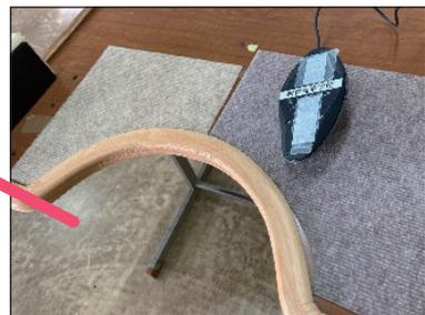
組み合わせカーペットをテーブルに貼り、トラックボールマウスの裏面に面ファスナーを付けて固定することで、トラックボールマウスの位置がずれることを防止できた。
