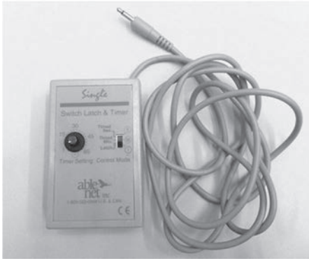
写真 16 市販のラッチ&タイマー： 現在はスイッチラッチ& タイマーデュアルとして 市販されている。
