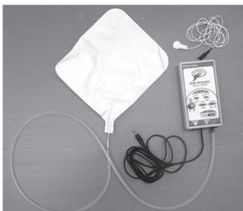
写真5 ピエゾニューマティックセンサー (PPS) スイッチ
