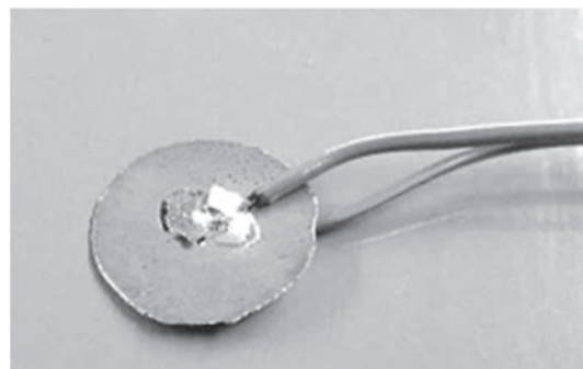
写真10 両面基盤にコードをはんだ付けした部分
