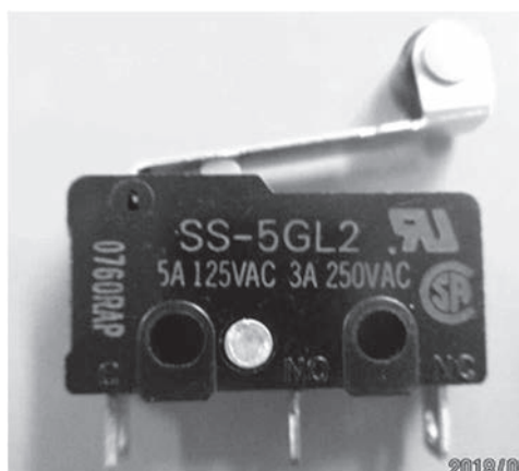
写真4 SS-5GL2 スイッチ（下部に3本の端子が見える）
