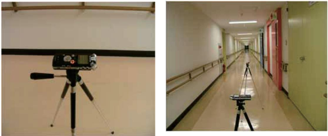
図 2-7 IC レコーダーとその設置の様子
