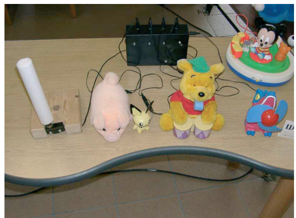
図3-1-5 Wing-MTB スキャンモード 4つのLEDが音に合わせて順に点灯し、好きなところでスイッチをONすると対応したおもちゃが動き始める。
