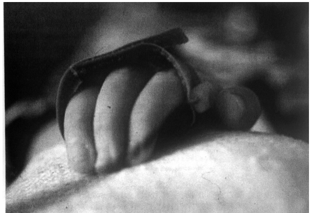
図1 - 3 - 2 親指のわずかな動きを検出する光ファイバセンサ
