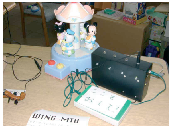
図3-1-4 Wing-MTB スタターモード スイッチをONするとLEDの点灯と「ピッ・ピッ・ピッ・ポーン」の音でおもちゃが動き始める。
